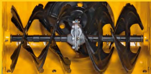
Die 2X Series beseitigt den Schnee im 2-Stufen-Verfahren. Die erste Stufe bildet eine quer liegende Fräseinheit, bestehend aus mehreren X-Segmenten. Durch ihre gezahnte Form beißen sich diese Segmente mühelos auch durch verharschten Schnee und ziehen diesen in das Fräsgehäuse ein. Die zweite Stufe ist ein schnell drehendes Propellerrad, welches den eingezogenen Schnee durch den Auswurfschacht bläst.
