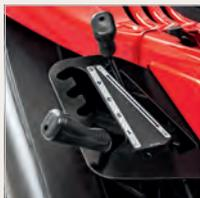
SCHNITTHÖHEN-VERSTELLUNG & MÄHWERKSCHNITTSTUFEN
